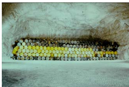
Abb. 1: Einlagerung von schwachradioaktiven Abfällen (Stapeltechnik)
