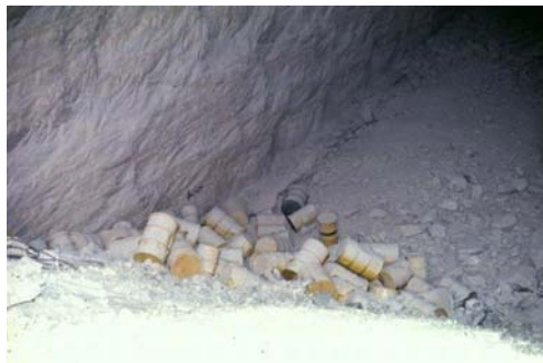
Abb. 5: Kammer mit schwachradioaktiven Abfällen und Salzversatz, Abkipptechnik
