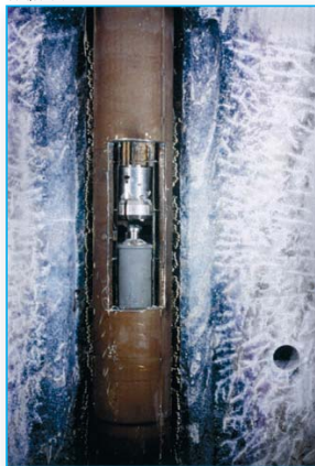
Deutsch-amerikanischer Gemeinschaftsversuch mit Kobalt-60-Quellen - Nach Versuchsende freigelegter Erhitzer. - Die als Blaufärbung sichtbare Strahlenschädigung des Steinsalzes ist auf eine radiolytische Strahlenwirkung zurückzuführen und reicht weniger als einen halben Meter in das Gebirge hinein.
