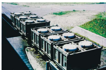
Als zusätzliche Abschirmmaßnahme wurden einige Fässer mit schwachradioaktiven Abfällen in Betonwalzen eingebettet. Diese Walzen wurden hauptsächlich über die Bahn antransportiert.
