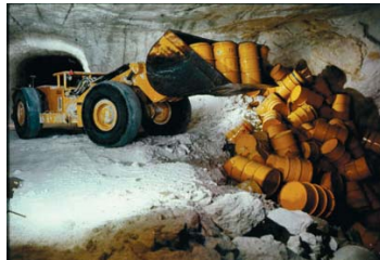
Am Ende der Einlagerungszeit wurden die Fässer mit den schwachradioaktiven Abfällen über eine Salzboschung in den Abbau abgekippt und anschließend mit Salzhautwerk bedeckt.
