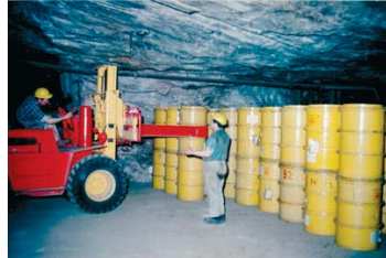
Zu Beginn der Einlagerung wurden die Fässer mit den schwachradioaktiven Abfällen senkrecht aufeinander stehend in die ehemaligen Abbaueingebracht.
